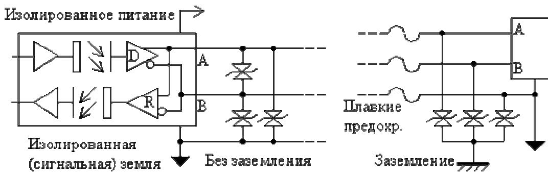
Защита ограничителями напряжения действенна при кратковременных перенапряжениях. При длительных - токи короткого замыкания могут вывести ограничители из строя, и устройства на линии окажутся без защиты. Для защиты от коротких замыканий в линию можно последовательно включить плавкие предохранители.
