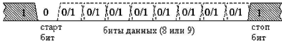
Перед началом связи между двумя устройствами необходимо настроить их приемопередатчики на одинаковую скорость связи и формат кадра.
