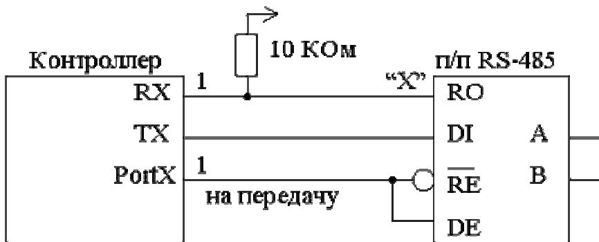
**Примечание:** у микроконтроллера AT90S8535 (AVR Atmel) есть глючок - при отключенном UART он все равно принимает, и после включения на прием первый принятый байт может быть испорчен. Так что активировать подтяжку RX ему нужно обязательно.
