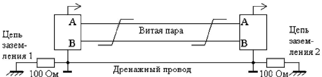
**Замыкание на высоковольтные цепи.** Если существует опасность попадания на линию или одну из местных "земель" высокого напряжения, следует применять опторазвязку или шунтирующие ограничители напряжения. А лучше и то и другое.
