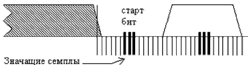
Поскольку бодрейт устанавливается делением системной частоты, при переносе программы на устройство с другим кварцевым резонатором, необходимо изменить соответствующие настройки UART.
