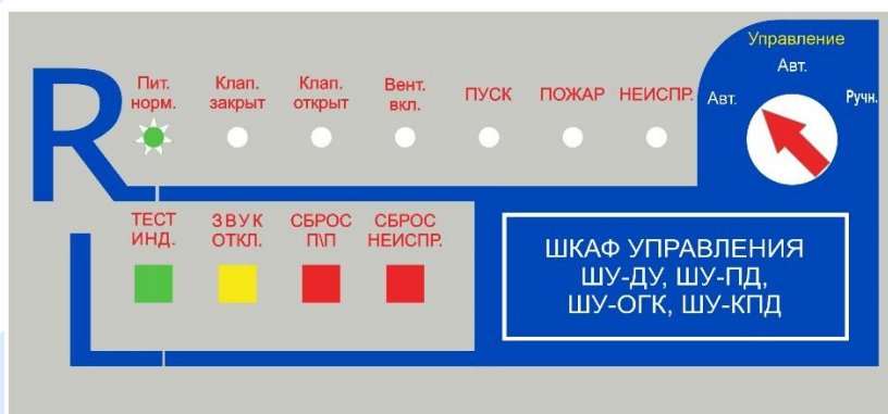
Рис. 2 Панель управления и индикации БРЛ-У-2
