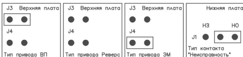
Изменение типа привода производить при выключенном блоке!
